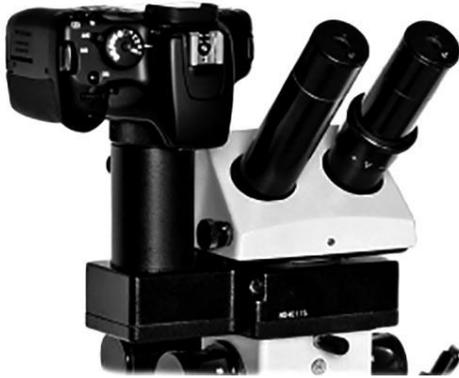
Изображение 38. Микроскоп МБС10 с установленным МФУ.
