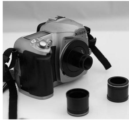
Изображение 39. Фотоаппарат с насадкой для установки вместо одного из окуляров микроскопа.
