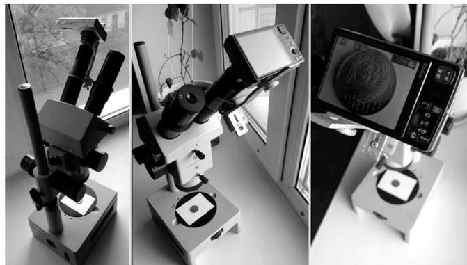
Изображение 40. Микроскопическая систем. с объективом, окуляром микроскопа и объективом фотокамеры.
