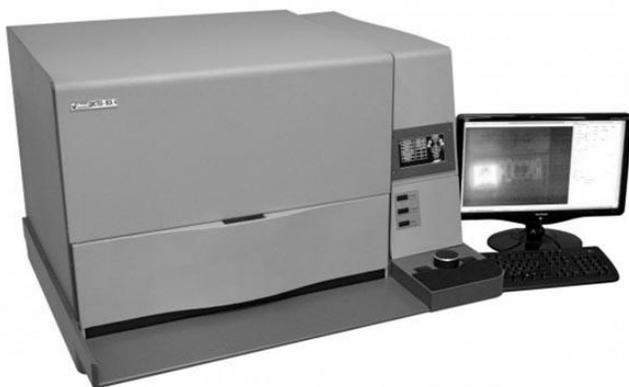
Изображение 48. Спектральный комплекс, предназначенный для проведения экспертиз, определения подлинности и исследования документов, банкнот, ценных бумаг и других материалов в различных спектральных диапазонах видимого, инфракрасного (ИК) и ультрафиолетового (УФ) участков в отраженном, косопадющем и проходящем свете.
