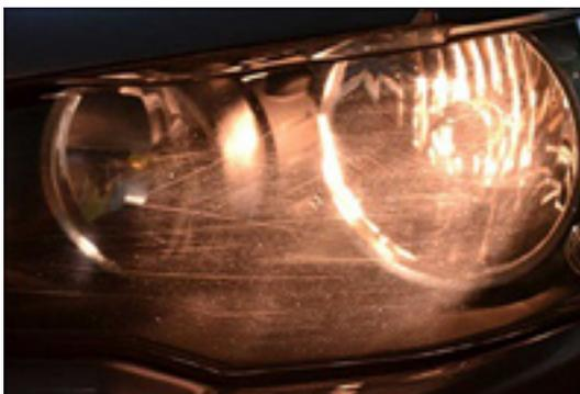
*Рис. 4. Эксплуатационные следы на фаре автомобиля.*
