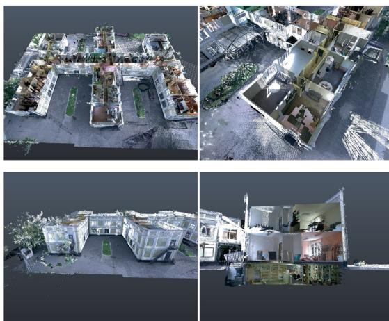
Рис. 1. Примеры видов проекций здания полученных при 3D сканировании.
