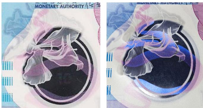
Рис. 4 Динамический сдвиг цветов G-Switch на гонконгской банкноте номиналом 10 долларов: а – вид под прямым углом зрения; б – вид под наклоном.
