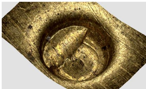
Рис. 7. 3D модель следа бойка на капсюле гильзы, стрелянной в 9 мм пистолете ИЖ-71.
