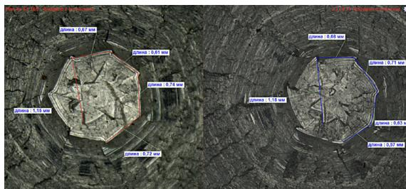
Рис. 5. Измерение и разметка сравниваемых следов сверления.
