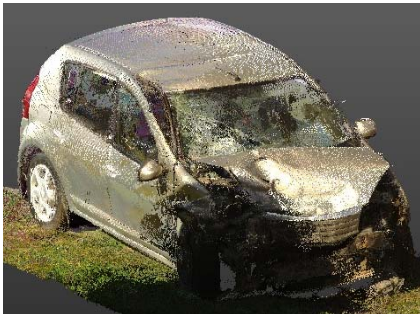
Рис. 6. Полученное с помощью технологии пространственного 3D сканирования облако точек, обработанного с помощью программного обеспечения «Trimble RealWorks».
