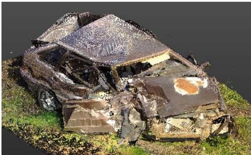
Рис. 5. Полученное с помощью технологии пространственного 3D сканирования облако точек, обработанного с помощью программного обеспечения «Trimble RealWorks».
