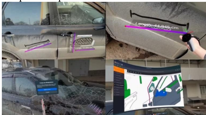
Рисунок 3. Процесс осмотра и измерений с использованием технологий дополненной реальности
