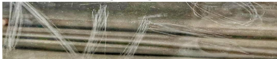
Рисунок 3. Вертикальная поверхность, изготовленная из стекла, надпись выполнена металлическим гвоздем
