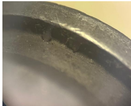
Рисунок 8. След от зацепа выбрасывателя на фланце гильзы от ПМ.
