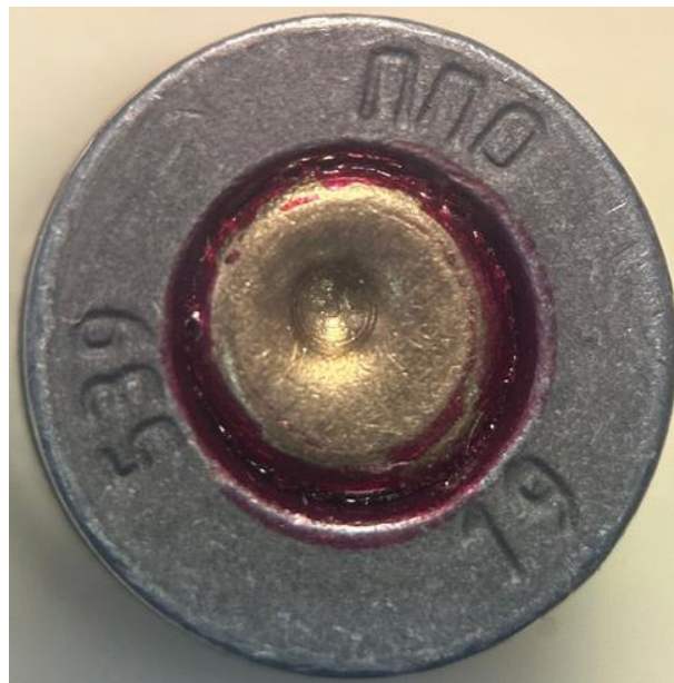
Рисунок 4. След от бойка ударника на донной части гильзы от ПМ.
