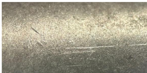
Рисунок 6. След от нижней грани затвора на корпусе гильзы от ПМ.
