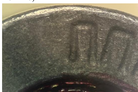
Рисунок 10. След от отражателя на донной части гильзы от ПМ.
