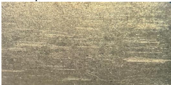
Рисунок 5. След от нижней грани затвора на корпусе гильзы от ИЖ-79-9Т.
